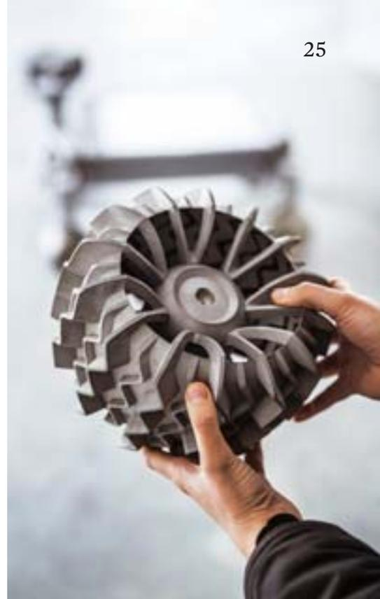
*Finnen an den Seiten der Räder verhindern, dass der Rover am Hang abrutscht. Die Idee steuerte ein Fahrer bei, als die Tüftler Tests in den Dünen der Wüste bei Katar durchführten*
